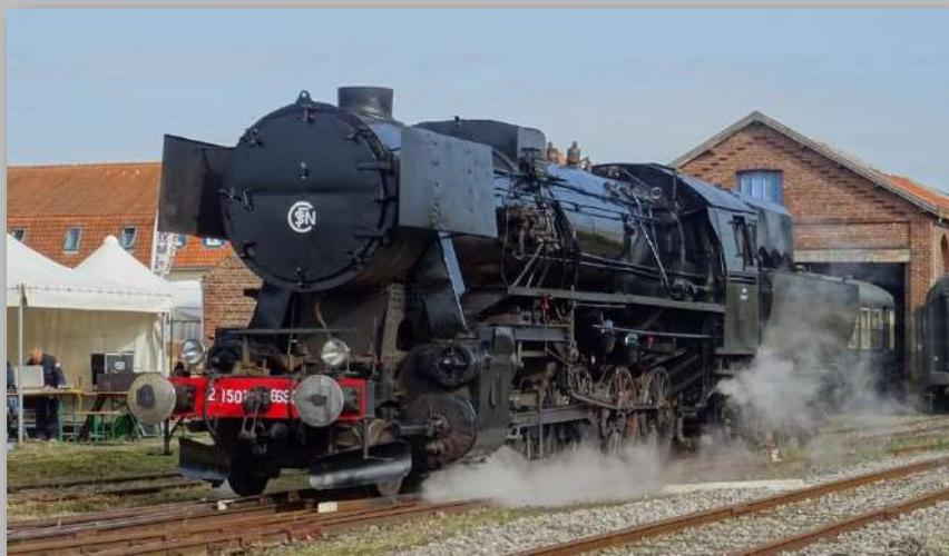
Deux grosses puissantes locomotives : la locomotive à vapeur 150Y du CFTVA et la locomotive diesel CC72084 de la SNCF :
