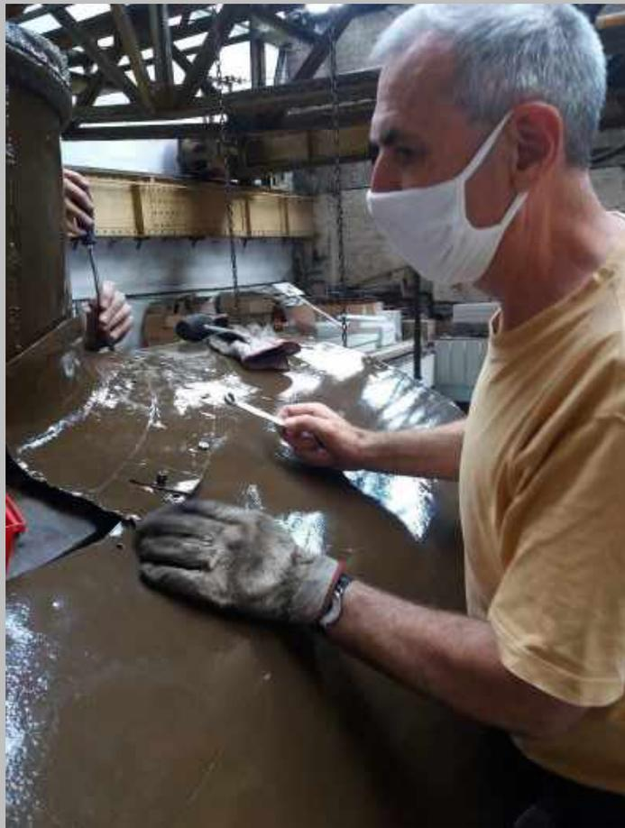
...suivi de la fixation de la tôle au cerclage de la chaudière
